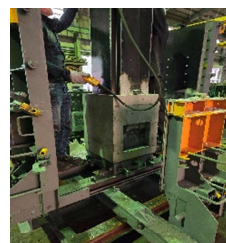
S y 樹型桝脱型状況
