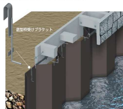
6. 底型枠の取り付け
